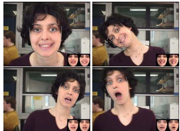
FIG. 1: Suivi de la pose et des mouvements faciaux, images 085, 366, 615 et 651. Sur chaque image, la forme dessinée correspond à l'état estimé du visage; les textures modèle et image \mathbf{g}_{modele}(\mathbf{c}_t) et \mathbf{g}_{image}(\mathbf{p}_t, \mathbf{c}_t) sont présentées dans le coin en bas à droite. h = 0.006
