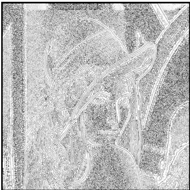
FIG. 4 – Contours et trois niveaux de gris obtenus à partir d'une image originale de Lena, avec bruit blanc additif, de moyenne 20 et d'écart-type 10.
