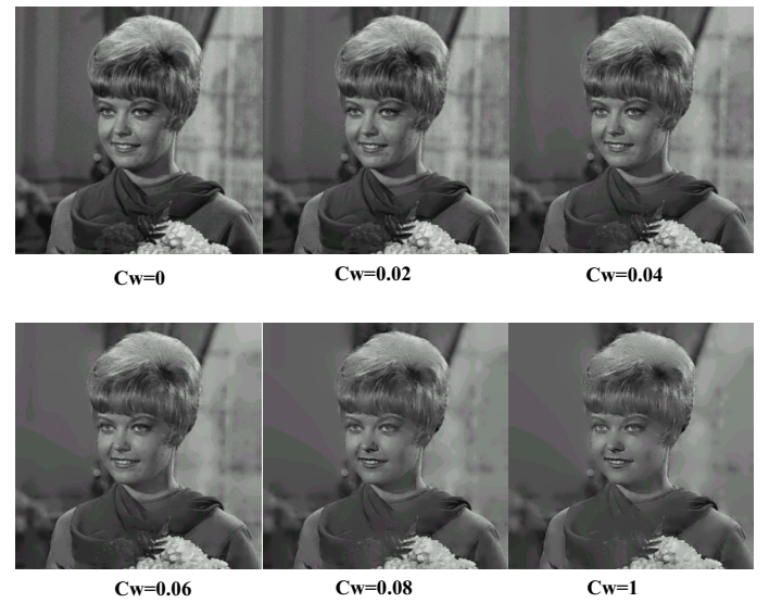
FIG. 5: Reconstruction de l'image par filtrage perceptuel avec différentes valeurs de C_w .
