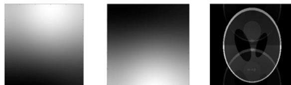
FIG. 4 : à gauche, les sensibilités estimées par la méthode ICASENSE puis lissées et interpolées, à partir des acquisitions de la figure 3. A droite, l'image reconstruite à partir de ces données et des images figure 3, en inversant l'équation (1).
